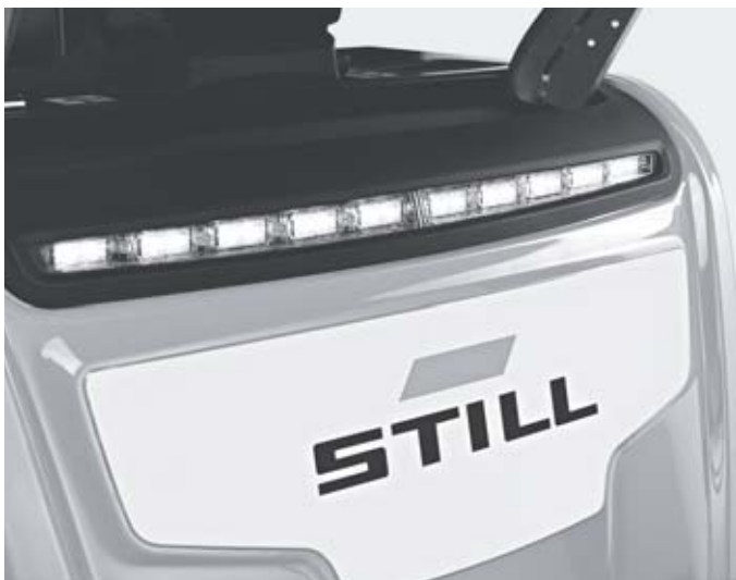
Lumina de zi inteligentă cu LED-uri asigură vizibilitatea autovehiculului și semnalizează bateria descărcată
