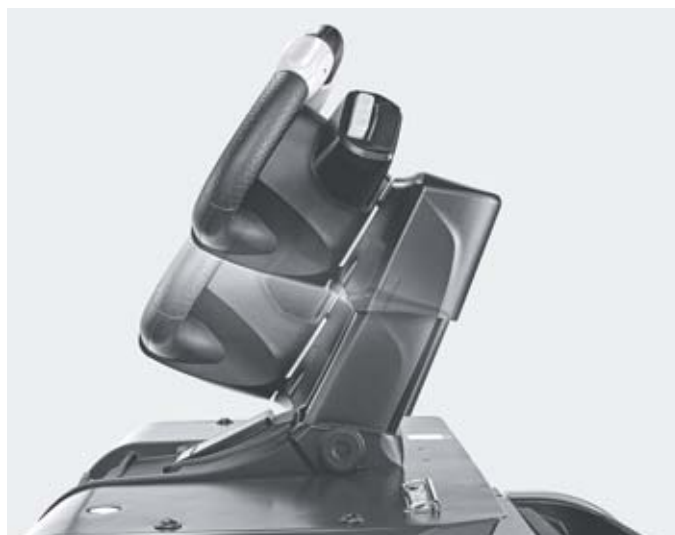
Ergonomie maximă datorită volanului reglabil în înălțime și cu un unghi ușor pentru preferințele individuale ale operatorului
