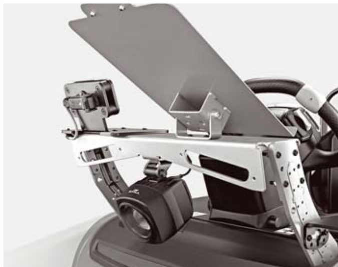
STILL Safety Light opțional pentru o mai bună percepție a autovehiculului și siguranță sporită
