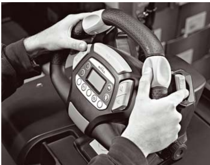
Volanul unic STILL Easy Drive pentru confortul în operare și comanda tuturor funcțiilor fără a fi necesară schimbarea poziției
